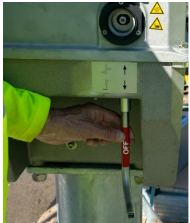
Figur 1 Drivmaskinnøkkel med sperrepinne i låst posisjon
