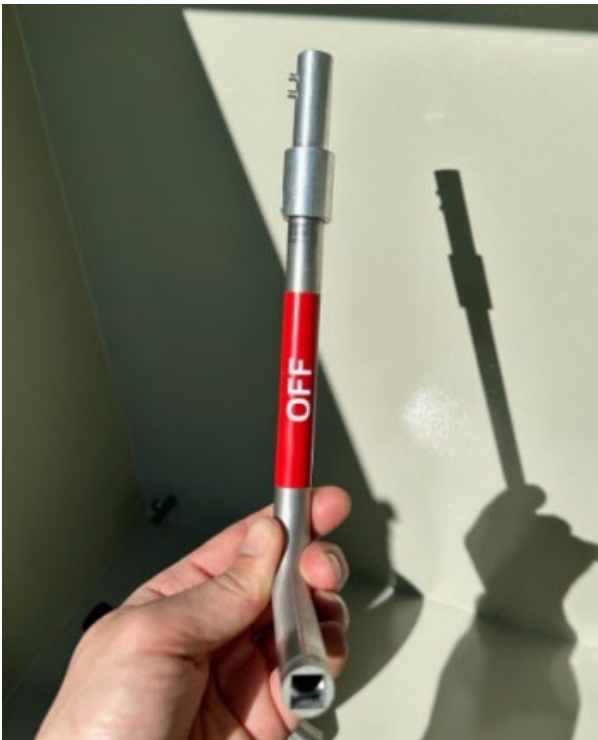
Figur 2 Drivmaskinnøkkel med sperrepinne
