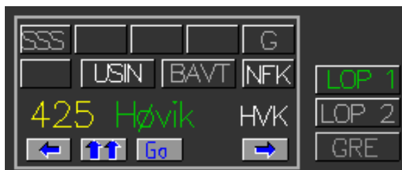
Figur 78 HVK i fjernstyrt modus med tilbudt kontroll for stasjonsstyring
