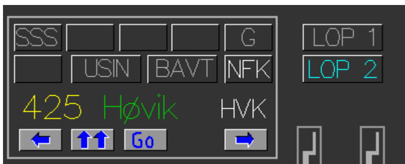
Figur 96 HVK i stasjonsstyrt modus av Thales LOP 2 med tilbudt kontroll for fjernstyring
