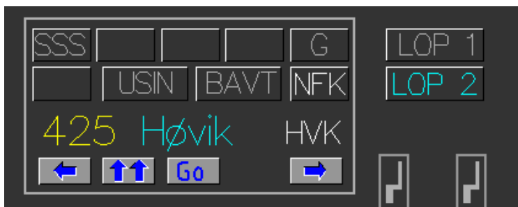
Figur 95 HVK i stasjonsstyrt modus av Thales LOP 2
