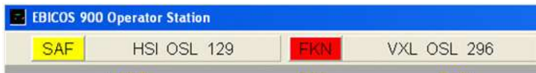
Alarmlinje med alarmgruppene SAF og FKN
