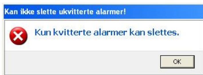
Figur 6: Fjerning av ukvittert alarm nektes av EBICOS 900
